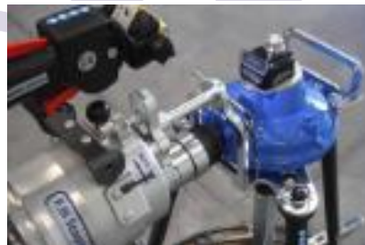
8. Conexão APB/APS - redutor RPM
